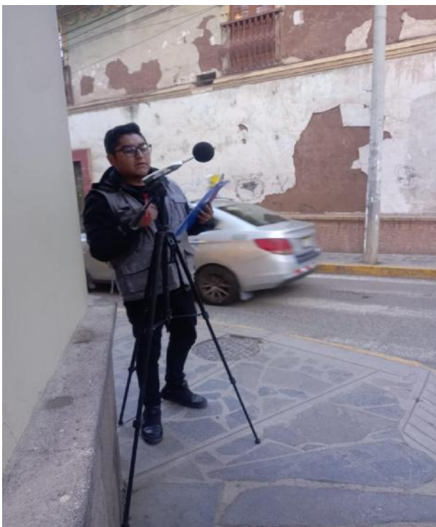
Figura 11. Monitoreo de nivel de ruido en las intersecciones del Jr. Arequipa y Jr. Puno
