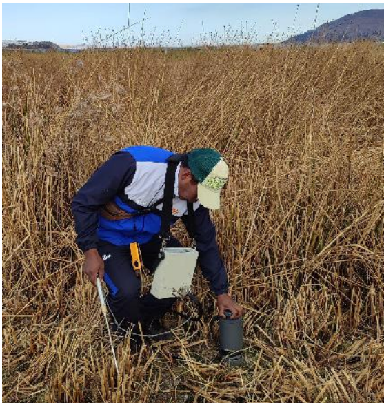
Figura 16: Colocando la cámara de respiración
