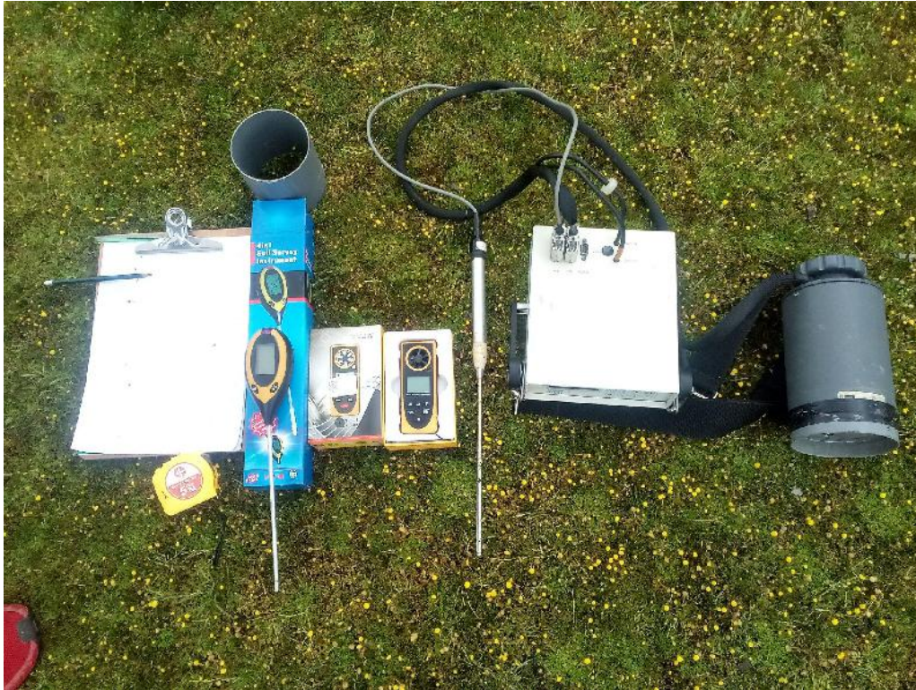
Figura 04: Materiales y equipos utilizados para la medición de flujo de CO 2 y variables ambientales
