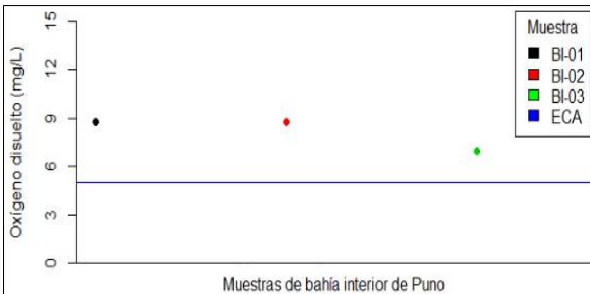
Figura 06: Oxígeno disuelto en el agua de la bahía interior de Puno.
