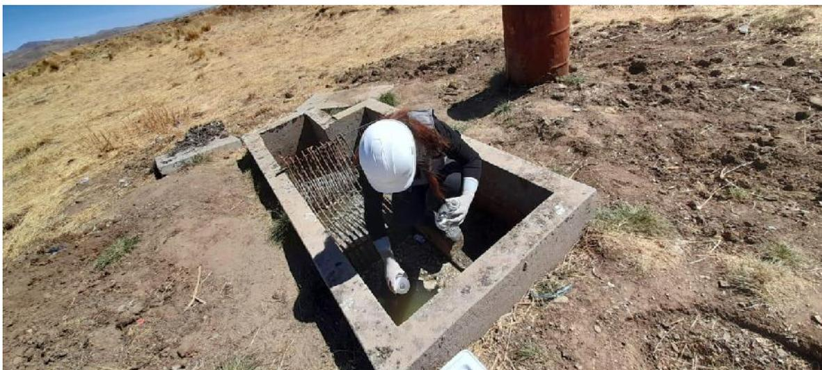
**Figura 16:** Recogido de la muestra del Efluente.
