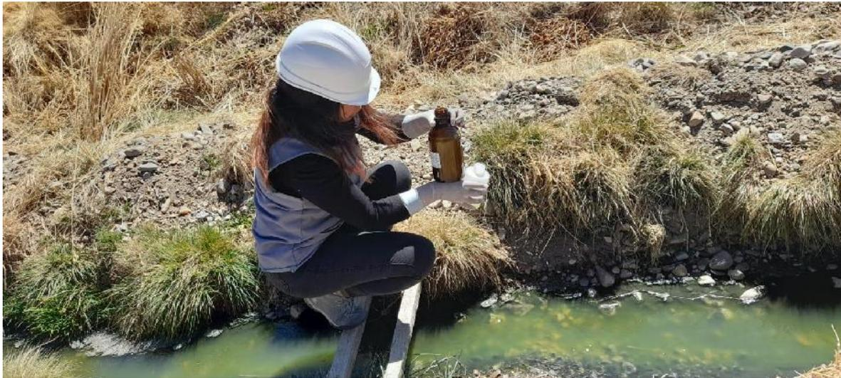
**Figura 11:** Verificación del envase a utilizar en el recojo de muestra en el Afluente.
