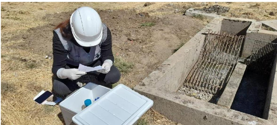
**Figura 19:** Verificación de los datos de la muestra del Efluente a enviar al laboratorio.
