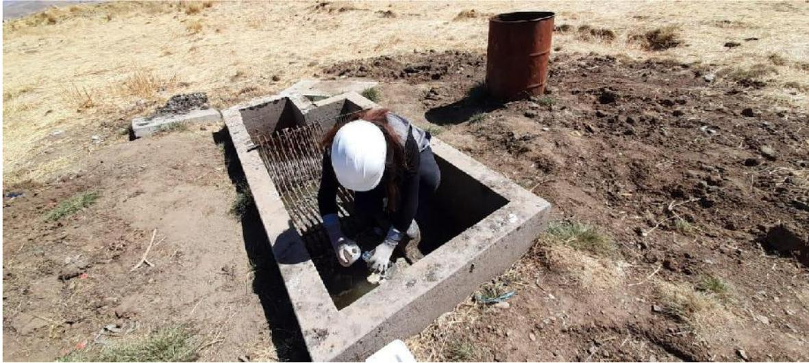
**Figura 14:** Recogido de la muestra del Efluente.
