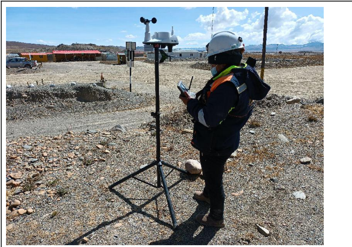
Figura 54: Programación de data logger del equipo meteorológico.
