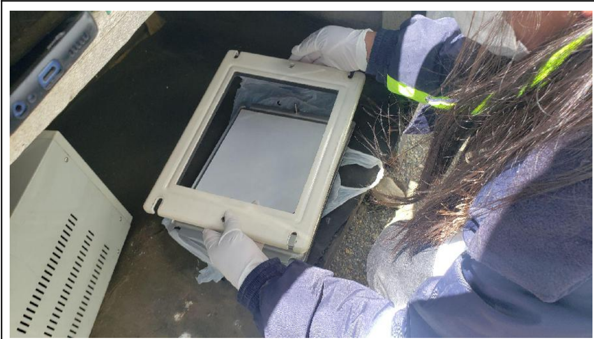
Figura 20: Ajuste del papel filtro de PM_{10} en el portafiltro del muestreador Hi-Vol.
