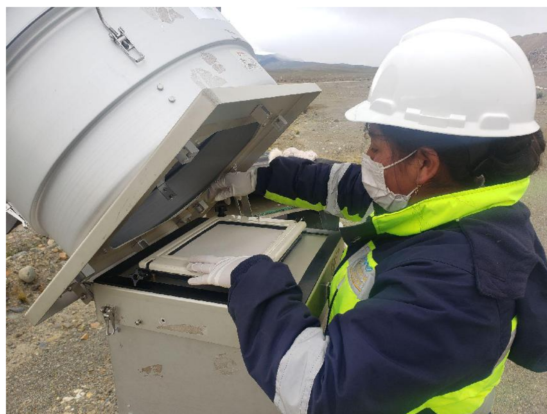
Figura 39: Desajuste de los pernos del portafiltro con la base del trapecio.
