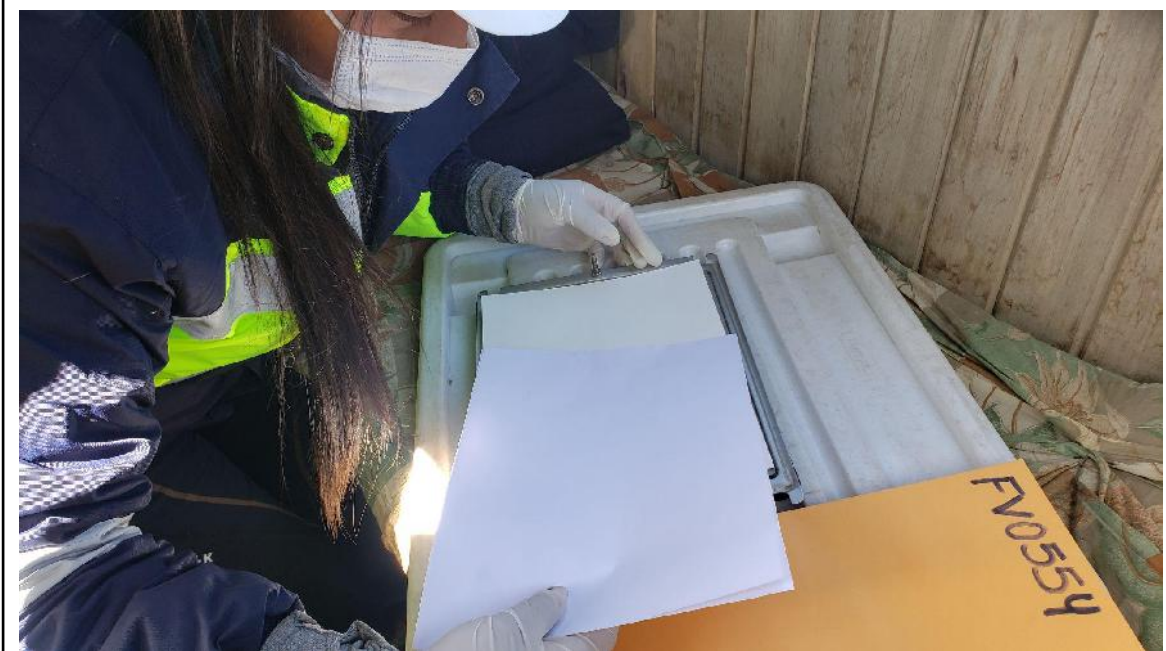
Figura 19: Instalación del papel filtro de PM_{10} sobre el portafiltro del muestreador Hi-Vol.
