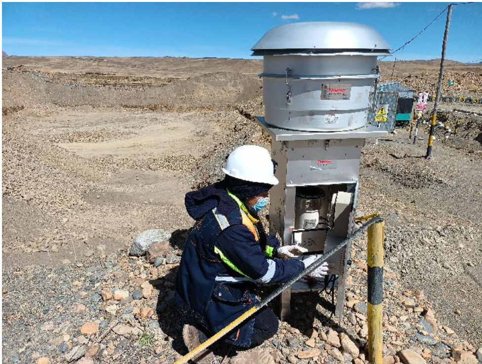
Figura 25: Programación del data logger del Equipo Hi-Vol.
