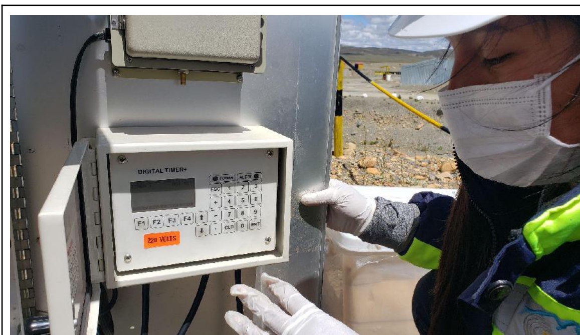
Figura 26: Programación del data logger de inicio de muestreo.
