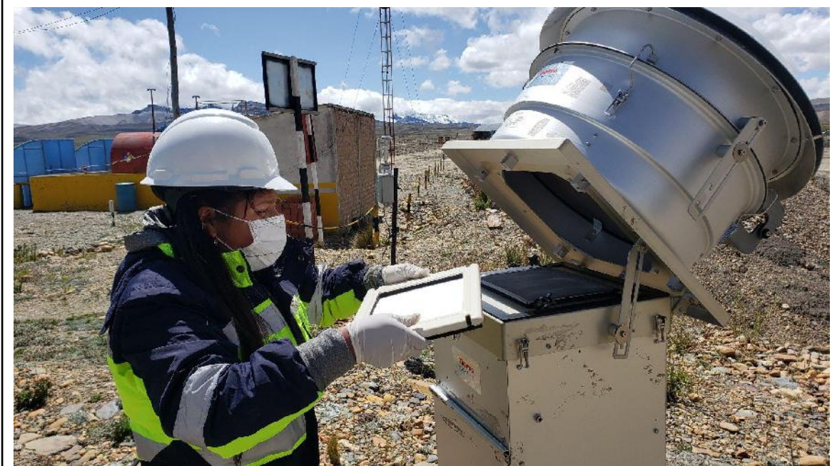
Figura 21: Instalación del portafiltro con filtro incluido para PM_{10} sobre el trapecio.
