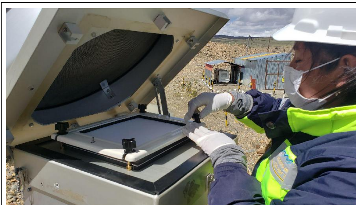
Figura 22: Ajuste del portafiltro en la base del trapecio, asegurando con pernos y tuercas.
