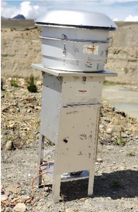
Figura 15: Equipo muestreador Hi-Vol instalado.
