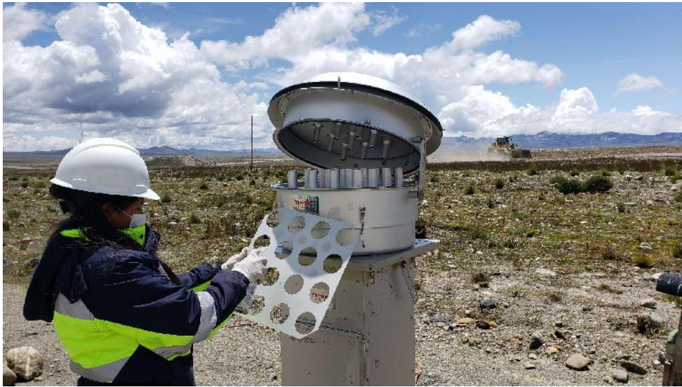
Figura 24: Impregnación con silicona fuera de los orificios del impactador del equipo.
