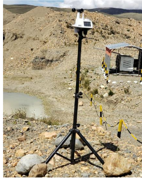
Figura 16: Equipo estación meteorológica instalado.
