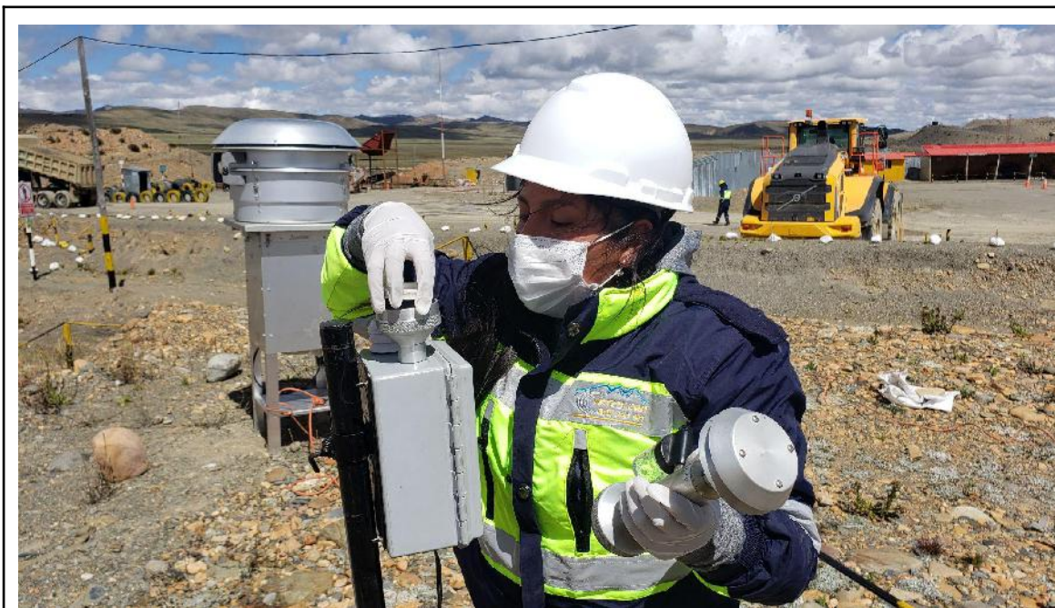
Figura 32: Instalación del portafiltro en el equipo muestreador Lo-Wol.
