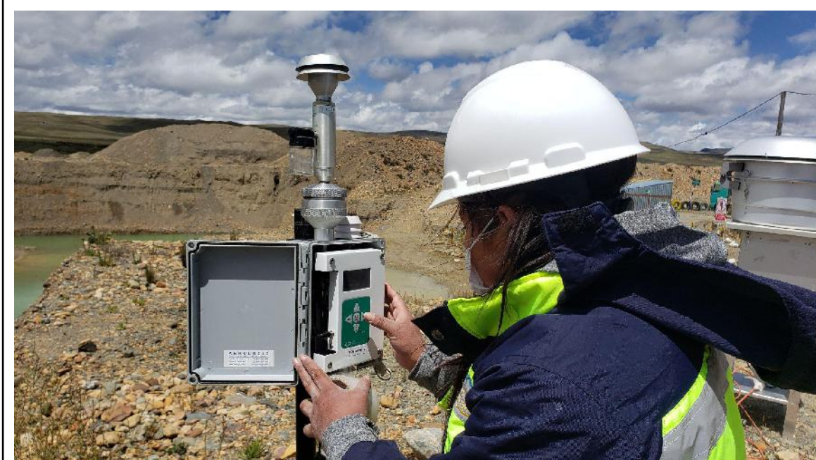
Figura 35: Programación del data logger para inicio de muestreo del PM_{2.5}
